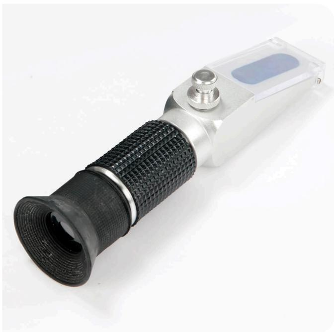
Lovibond® 乙二醇折光仪为测定发动机冷却液和防冻液中的乙二醇浓度提供了一种方便、快速和准确的方法。该光学仪器使用简单、清洁，并提供了基于比重计的传统方法不可能实现的即时结果。由于自动温度补偿，可以立即、准确、直接读取测量结果，无需额外的温度测量或应用校正因子。折光仪的标度方便直接读取凝固点和乙二醇和丙二醇的浓度。
